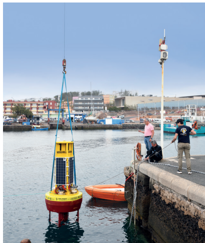
Instalación inicial de la boya en el muelle de Taliarte para la fase de prueba y verificación de los instrumentos científicos y las comunicaciones.
