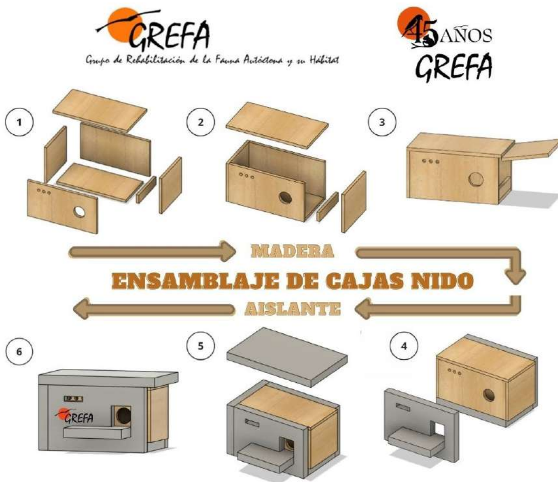
Secuencia de montaje de caja nido, primeramente estructura de madera y a continuación recubrimiento con aislante térmico.
